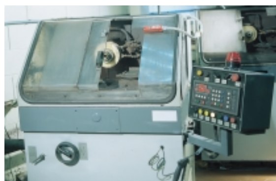
Macchina tagliaferrite computerizzata Cortaferritas computerizada Machine à scier pour ferrite mécanisée Computerized ferrite cutting machine Rechnergesteuerter Ferrit-Schneideautomat
